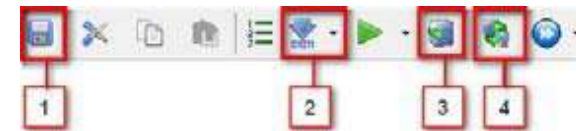
Рисунок Д.10 – Панель конфигурирования ПЛК. 1- Сохранить проект, 2 - построить конфигурацию для верхнего уровня, 3 – загрузка конфигурации в ПЛК, 4 – запуск глобального опроса (всех устройств)
